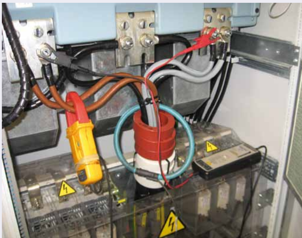
Common mode stroomvormanalyse aan de uitgang van een frequentieregelaar
