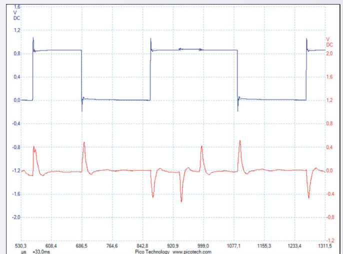
Figuur 3. Common mode piekstroom met common mode filter
